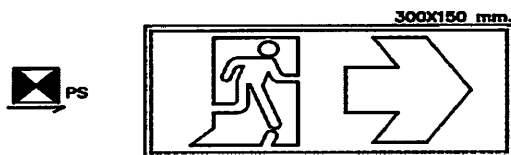
ป้ายหนีไฟให้ไปทางขวา แบบด้านเดียว วัสดุผลิตจากอลูมิเนียม
